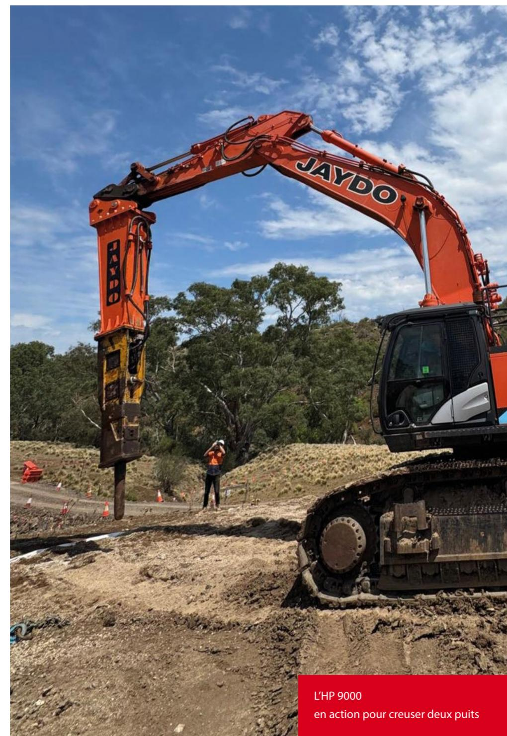
L'HP 9000 en action pour creuser deux puits
