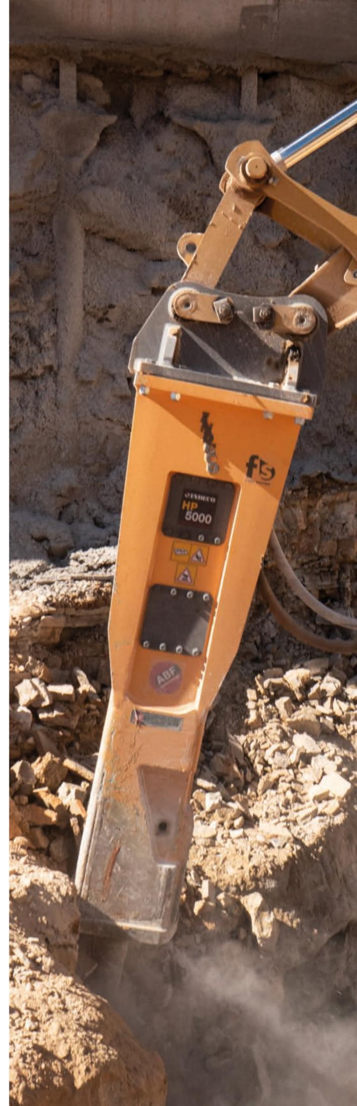
les brise-roches de sa gamme. Le HP 7000 et les deux HP 5000 utilisés pour creuser la tranchée sont en effet équipés d'un système hydraulique spécial capable de faire varier automatiquement l'énergie et la fréquence des coups en fonction de la dureté de la roche. La puissance hydraulique délivrée par la pelle est
