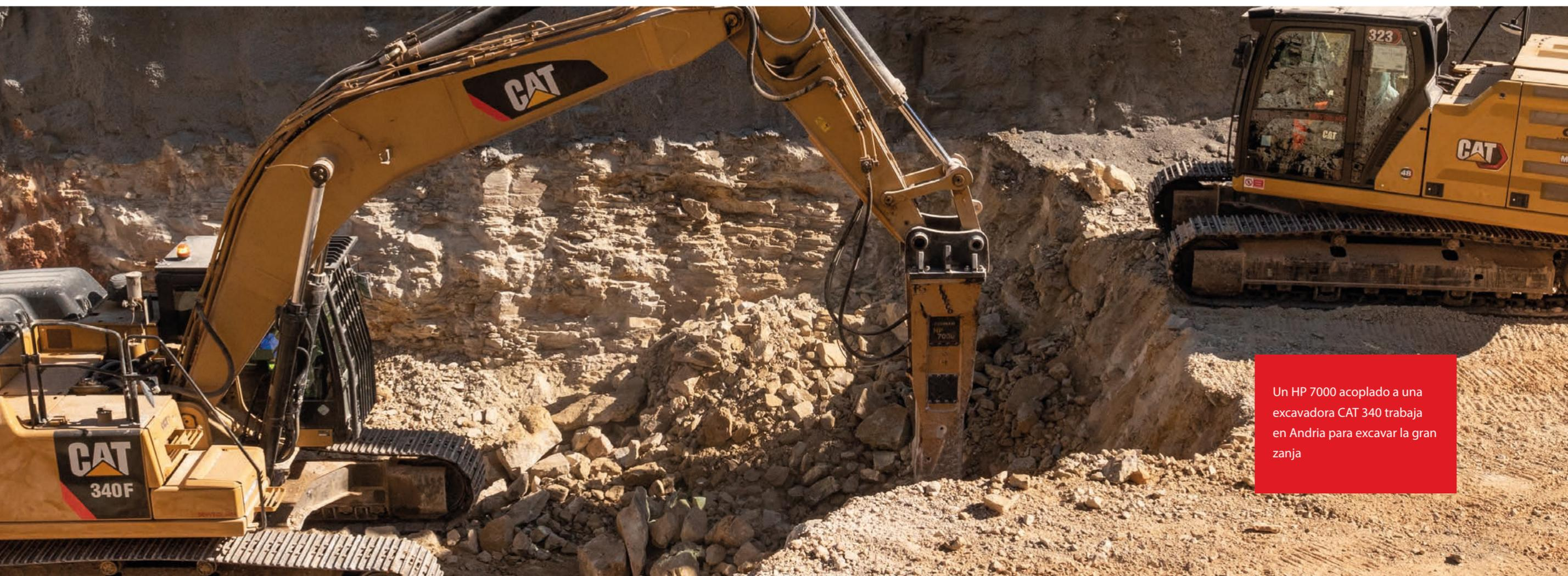
Un HP 7000 acoplado a una excavadora CAT 340 trabaja en Andria para excavar la gran zanja
