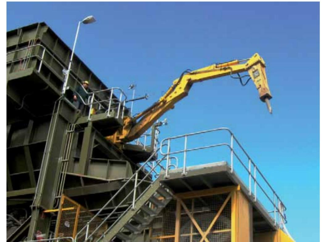
Der Positionierarm Indeco IBS, der bereits seit einigen Jahren von Indeco Nord America und Indeco Australia hergestellt und vertrieben wird, hat Zukunft auf zahlreichen anderen Märkten, da er große Vorteile für die Produktionslogistik in Steinbrüchen und Bergwerken bietet. Er wird in der Nähe der Einfüllöffnungen der Brecheranlagen montiert und dann für die Zerkleinerung von großen Blöcken verwendet, die den Brecher blockieren könnten. Dadurch wird eine unterbrechungslose Produktion
