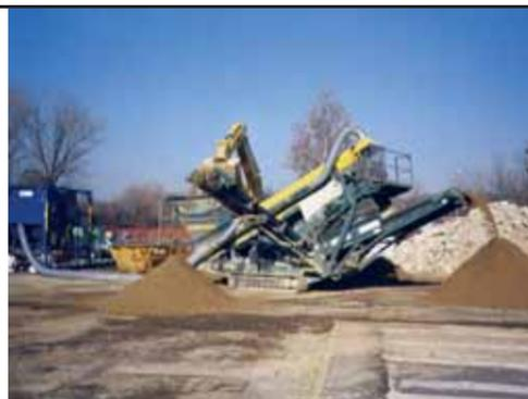
*Equipo móvil de fragmentación aplicado a instalación móvil de criba. ■*
