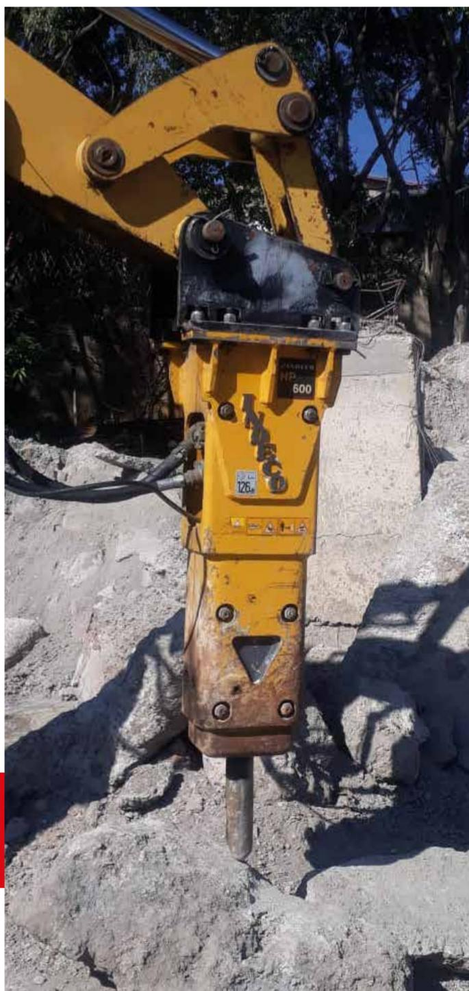
Der Hammer, der 490 Stunden mit einer Produktion von 150 m<sup>3</sup> pro Tag verwendet wurde
