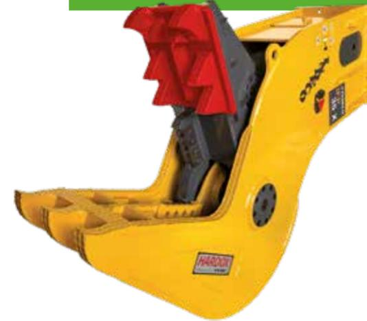
Por lo que respecta a los **quebrantadores fijos (IFP) y giratorios (IRP)**, además de algunas mejoras dirigidas a incrementar su robustez, los nuevos modelos disponen de dientes intercambiables en la mordaza móvil (soldados sobre una placa atornillada y asegurada mediante cierres especiales) para una óptima penetración en el material a demoler.
