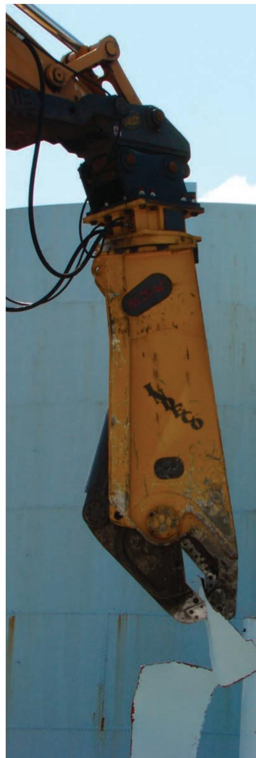
Com cinco modelos disponíveis foi complementada a linha das cortadoras ISS. Projetadas especialmente para o corte de materiais ferrosos, como perfis, reservatórios e tubulações as cortadoras Indeco ISS se distinguem pela excepcional capacidade e força de corte devida às seguintes características de construção peculiares:
