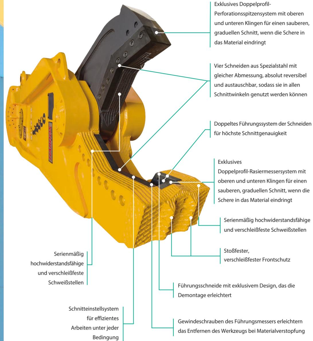
Exklusives Doppelprofil-Perforationsspitzenystem mit oberen und unteren Klingen für einen sauberen, graduellen Schnitt, wenn die Schere in das Material eindringt
