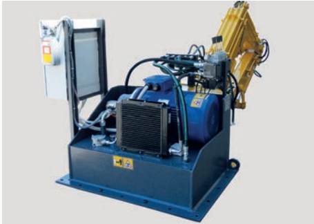
Centralita/grupo de potencia de a bordo, motor eléctrico trifásico
