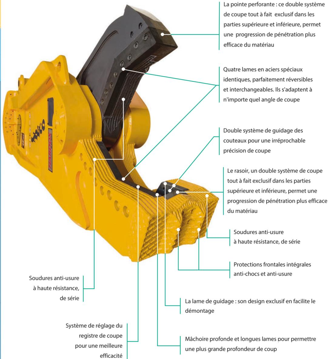
La pointe perforante : ce double système de coupe tout à fait exclusif dans les parties supérieure et inférieure, permet une progression de pénétration plus efficace du matériau
